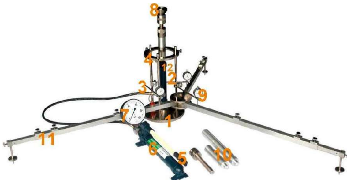
Rys. 1.2 Aparatura VSS z jednopunktowym pomiarem przemieszczenia płyty
