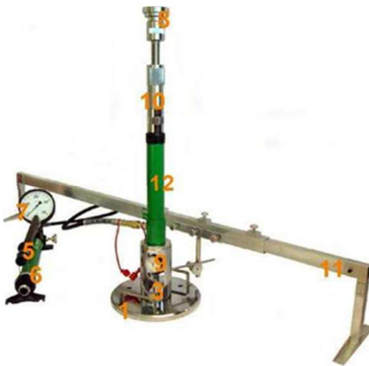
Rys. 1.2 Aparatura VSS z jednopunktowym pomiarem przemieszczenia płyty
