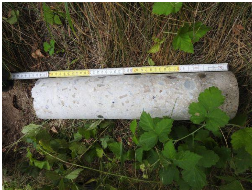
Fot. 4.4 Widok na odwiercony rdzeń betonowy.
